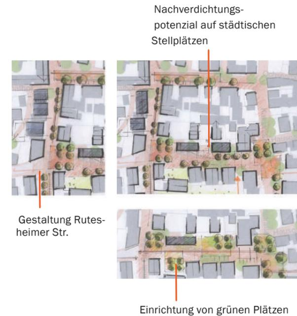
Abb.149 Varianten Neustrukturierung entlang Rutesheimer Straße und Hausgasse mit Neubauten zur Definition der Raumkanten
